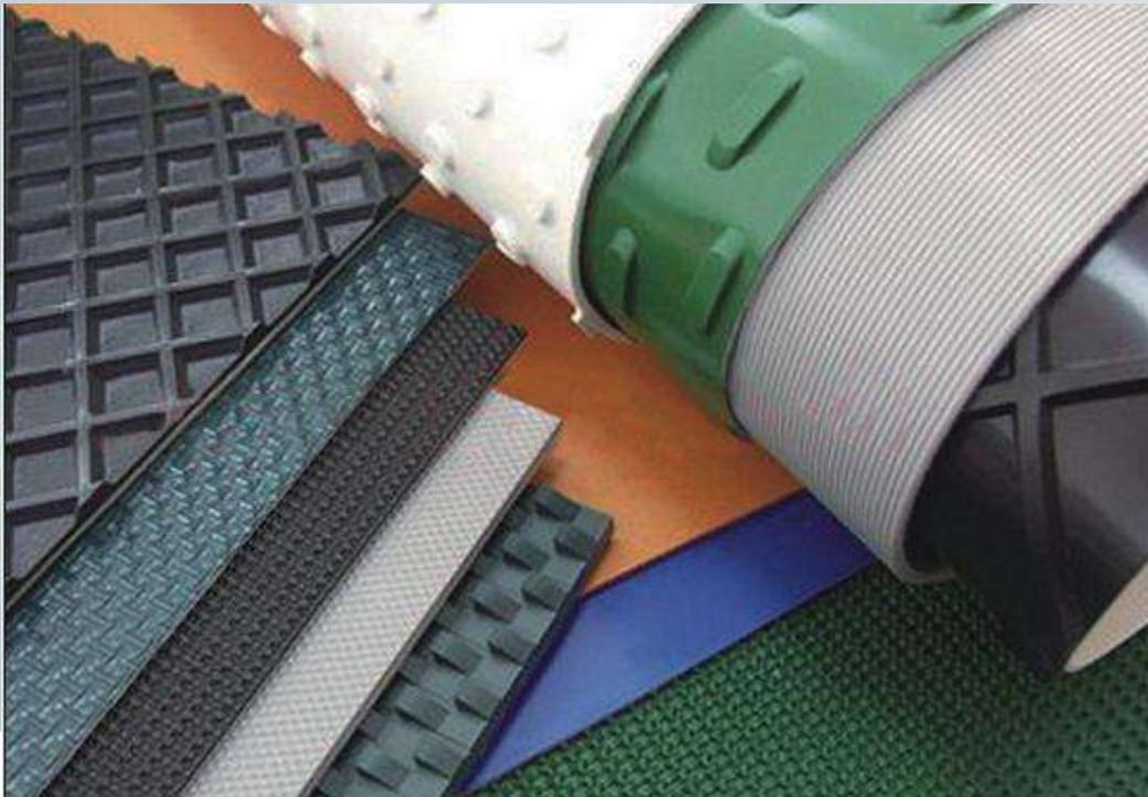
Existen bandas transportadoras para uso ligero y uso pesado. La banda es arrastrada por fricción por uno de los tambores, que a su vez es accionado por un motor. El otro tambor suele girar libre, sin ningún tipo de accionamiento, y su función es servir de retorno a la banda. La banda es soportada por rodillos entre los dos tambores.
