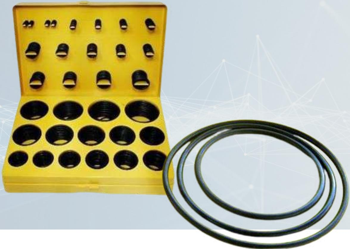
**Características /** Sello en forma de anillo de sección circular. Se utiliza en diversos tipos de elementos de máquinas. Se le considera un sello simple que puede tener su uso en condiciones estáticas o dinámicas. La acción del sellado es el resultado de la deformación axial o radial de la sección transversal del Arosello montado.
