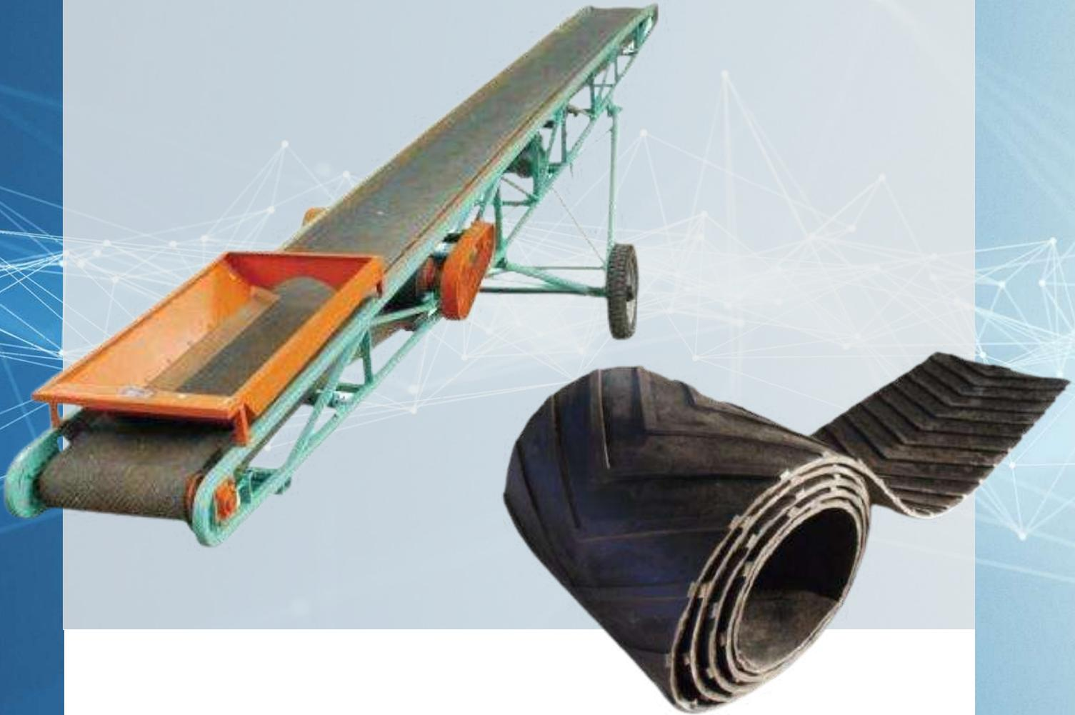
Para transportar material por terreno inclinado se usan unas secciones llamadas cintas elevadoras. Existe una amplia variedad de cintas transportadoras, que difieren en su modo de funcionamiento, medio y dirección de transporte, incluyendo transporte de tornillo, los sistemas de suelo móvil, que usan planchas oscilantes para mover la carga, y transportadores de rodillos, que usan una serie de rodillos móviles para transportar cajas o palés.
