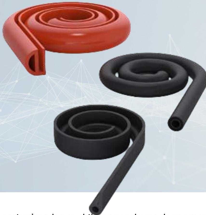
Los perfiles extrusionados, se obtienen por el paso de una mezcla de caucho por el interior de una extrusionadora en cuyo extremo esta montada una hilera que nos da el perfil de la pieza.
