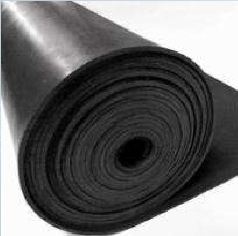
De baja permeabilidad al aire. Excelente resistencia a la oxidación y ozono, al calor y a la impermeabilización de gases. Muy baja resiliencia, lo que proporciona una elevada capacidad de amortiguación de impactos o vibraciones no sostenidas. Campo de temperaturas entre  $-45^{\circ}\text{C}$  y  $130^{\circ}\text{C}$ . Moderada resistencia a la abrasión.
