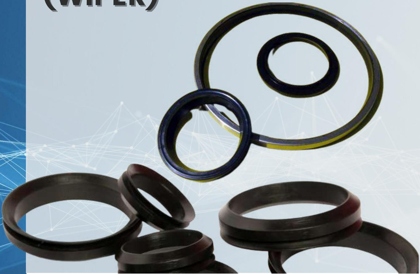
**Características /** Se utiliza para remover suciedad y partículas abrasivas que se depositan en los ejes de cilindros neumáticos e hidráulicos. El tamaño y la forma del labio limpiador aseguran que se mantenga el contacto con la superficie del vástago a pesar de agentes tan variados como barro, hielo, petróleo, cemento, etc. De esta forma protege a las guarniciones que trabajan dentro del cilindro y alarga su vida útil.
